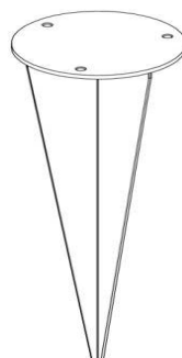
Mocowanie do podłoża naturalnego
